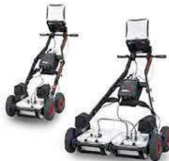
Fig. 2 - RIS MF Hi-Mod: configurazioni a 1 e 2 moduli multifrequenza
