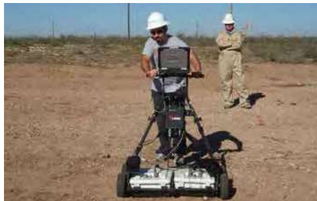
Fig. 1 - RIS MF Hi-Mod: rilievo su terreni accidentati
